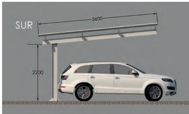
Acabados: Pilares, vigas y correas en acero galvanizado en caliente por inmersión Calidad del acero S275 Tornillería A2/70 Opción con chapa: Cubierta de chapa metálica prelacada color blanco pirineo
